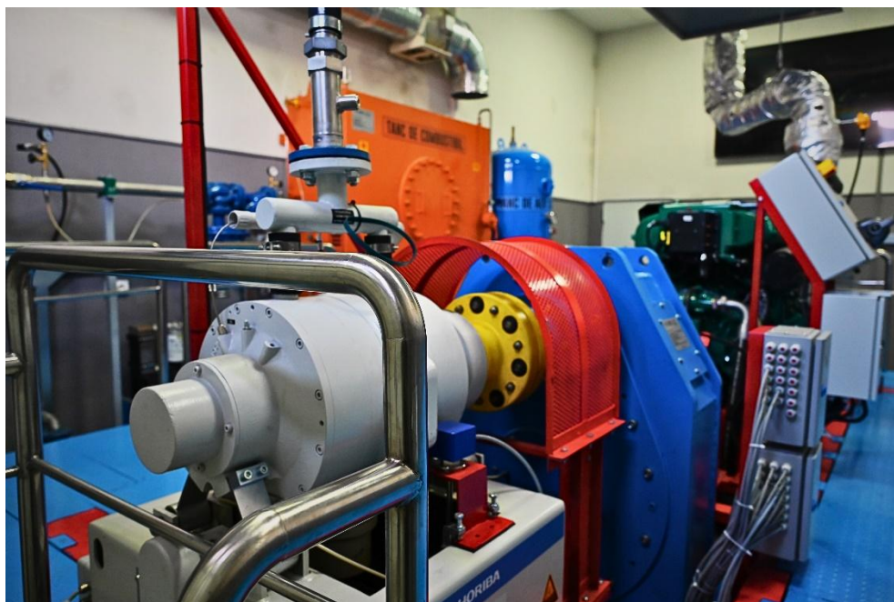
Frână hidraulică pentru simulare încărcare elice
